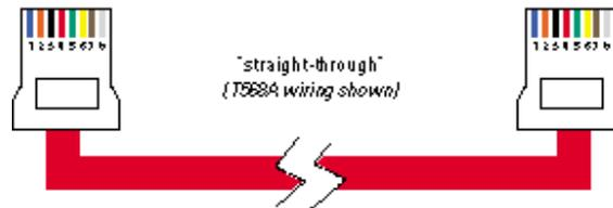
Este tipo de cables es utilizado para conectar PCs a equipos activos de red, como Hubs, Switchers, Routers.
